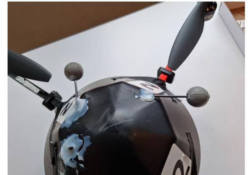
Fixation des marqueurs Motion Capture à un drone mikrokopter
